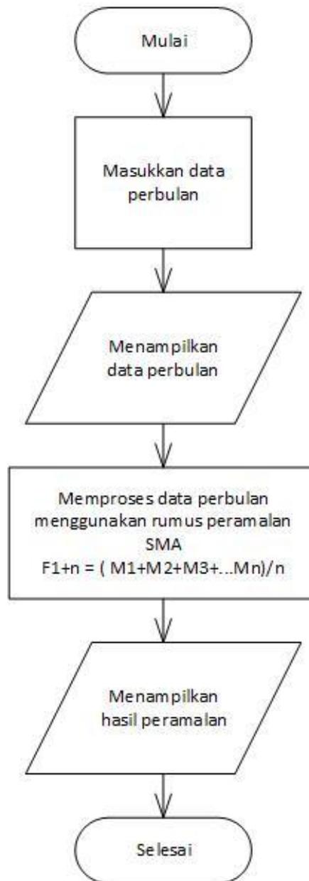
Gambar 4. Alur perhitungan metode SMA
