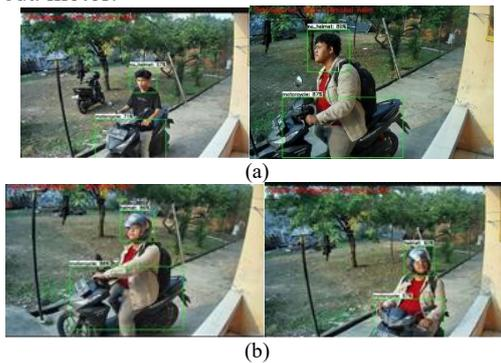
Gambar 11. Hasil pengujian deteksi (a) Tidak menggunakan helm (b) Menggunakan helm
