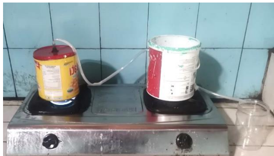
Gambar 4. Alat destilasi sederhana memanfaatkan limbah anorganik
