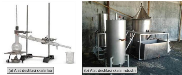
Gambar 2. Alat destilasi sederhana (a) skala laboratorium kimia dan (b) skala industri
